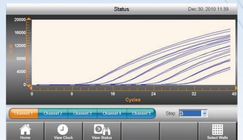
在彩色屏幕上可直接实时显示每个样品孔的扩增曲线。
